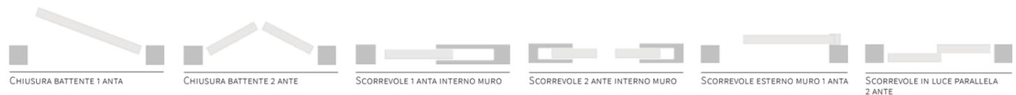
CHIUSURA BATTENTE 1 ANTA    CHIUSURA BATTENTE 2 ANTE    SCORREVOLE 1 ANTA INTERNO MURO    SCORREVOLE 2 ANTE INTERNO MURO    SCORREVOLE ESTERNO MURO 1 ANTA    SCORREVOLE IN LUCE PARALLELA 2 ANTE
