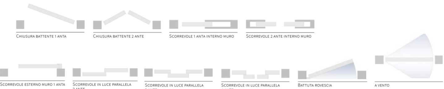
CHIUSURA BATTENTE 1 ANTA    CHIUSURA BATTENTE 2 ANTE    SCORREVOLE 1 ANTA INTERNO MURO    SCORREVOLE 2 ANTE INTERNO MURO    SCORREVOLE ESTERNO MURO 1 ANTA    SCORREVOLE IN LUCE PARALLELA 2 ANTE    SCORREVOLE IN LUCE PARALLELA 3 ANTE    SCORREVOLE IN LUCE PARALLELA 4 ANTE    BATTUTA ROVESCIA    A VENTO
